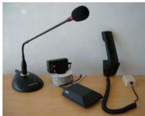
El generador de inducción dispone de tres tipos de entrada de audio, una mediante un conector XLR balanceado, de 6.3 mm mono, y una última por conector RCA, pudiendo elegirse cualquiera de estas.
