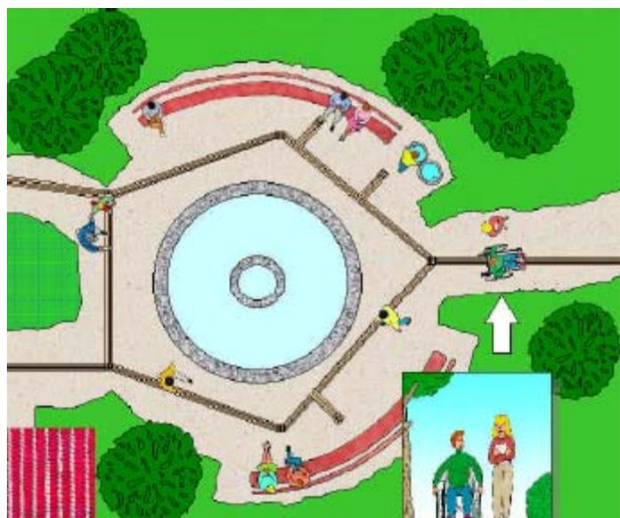
marcha, realiza un itinerario continuo, sin intervalos, aún cuando existan cambios de cota o desniveles. Además, cuando haya puntos de intersección (la franja guía se divide en varias para llegar a diferentes puntos de interés) el pavimento de la franja cambiará, de manera que pueda ser detectado que existe esta diversificación de caminos.
