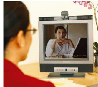
**VIDEOTELÉFONO:** Es un sistema ideal para la comunicación telefónica de personas con discapacidad auditiva. Consiste en un terminal telefónico con teclado y pantalla mediante el cual se transmite y recibe imagen y sonido.
